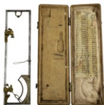
L'hygromètre à cheveux, invention d'Horace Bénédict de Saussure.
